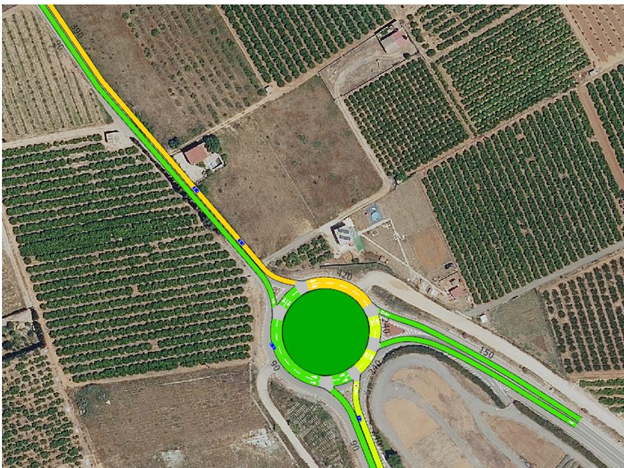
Red simulada Estado Futuro Con Implantación / Detalle GL 04 Resultado FLUJO. Fuente: Elaboración propia
